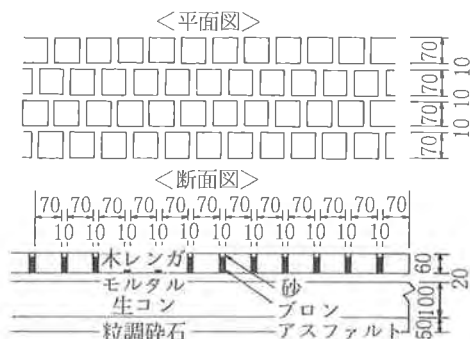
図－2 木レンガ舗装標準断面図
