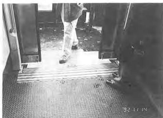
写真-12 開扉と同時に金属板が出される。
