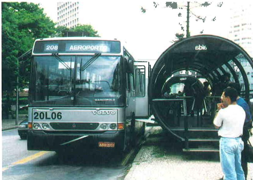
クリチバ（ブラジル） クリチバ（ブラジル）もバスの機能を高度に充実させ、幹線バスのコリダー上に容積が重点的に配置された都市である。バスのネットワークは、急行バスから中心部バスまで6種に分類され、それに応じて車種や塗装が区別されている。写真は、特別の車両と停留所を設けた急行バスであるが、運賃收受時間のカットと水平乗降を可能にして、速達性を確保している。
