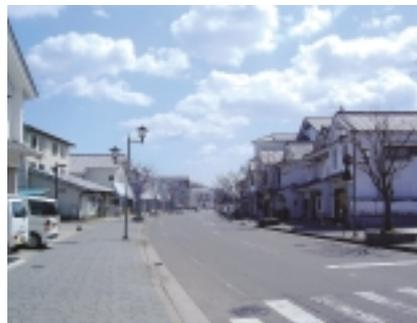
無電柱化の実施(裏配線) 歩道舗装の修景(擬石ブロック張)等の対策を実施。更に、沿線に歴史的建造物が存在する区間は、道路幅員を12mに縮小(基本は16m)し都市計画決定することで建造物の保全・活用を図った。
