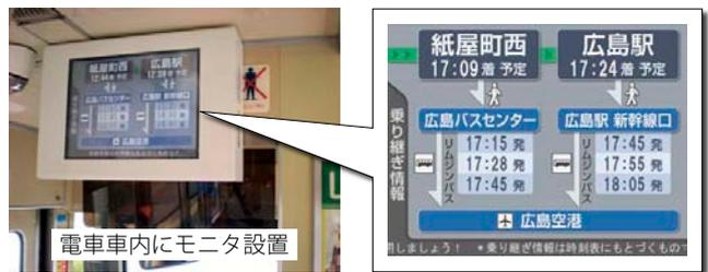
図-3 電車内における乗継情報提供システム
