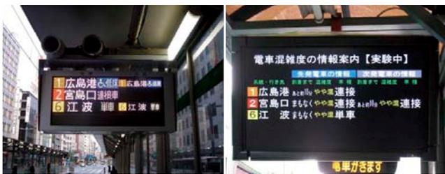
図-1 電車の情報提供システム
