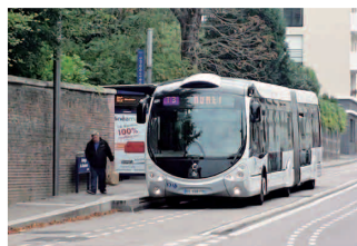
写真－1 ルーアンのCIVIS方式 （バス停前後は白線でガイド）
