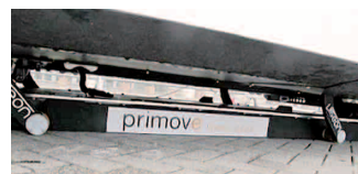
写真－１６ 車両側の電磁コイル
