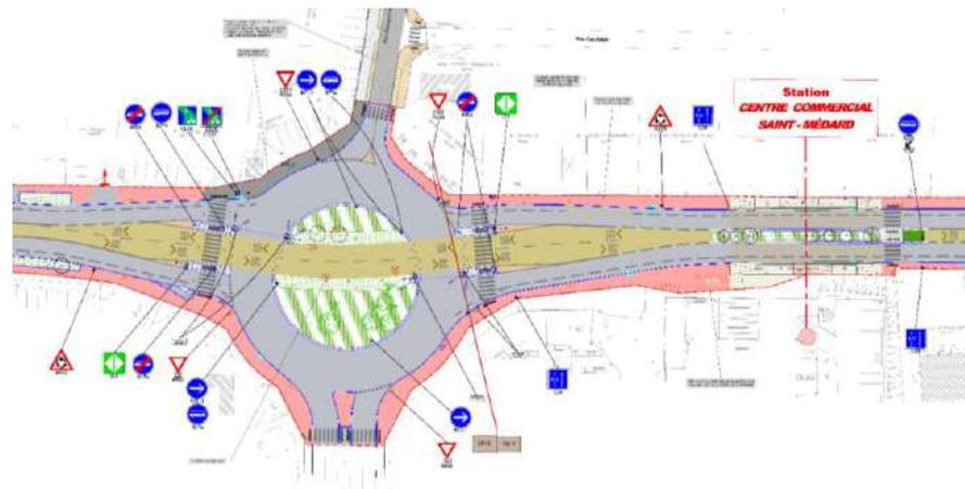
▲バスが直進するラウンドアバウト図面例（バス専用空間）【ボルドー（仏）】
