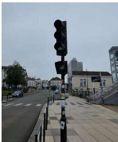
バス優先信号制御によりバス接近と連動し、バスは完全停車せずスムーズに交差点を通過。
