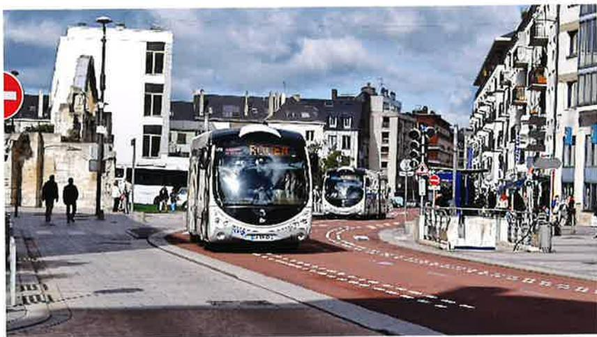
BRT (Bus Rapid Transit) は、従来の路線バスよりも速達性が高く、都市内あるいは都市圏域の基幹的な公共交通軸を形成しうる新たなバス交通システムです。また、海外のバス先進国では、BHLS (Bus with a High Level of Service) と呼ばれるカテゴリーのシステムも存在しています。既存のバス交通をベースに、BRTと同様、大量輸送や高い定時性、運行時間の拡大や徹底したバリアフリー化など、あらゆる面において利用者の視点に立った質の高いサービスを提供する新たなバス交通システムです。
