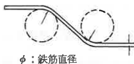
図-2.2.14 折曲鉄筋の曲げ半径
