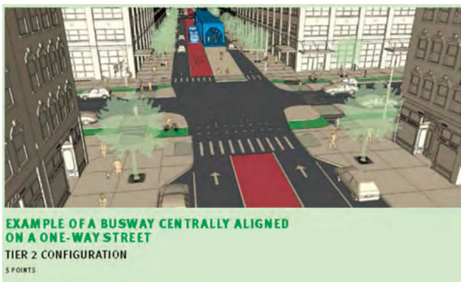
図-2 片方向のバスレーンを向かい合う一方通行の中央に配置した例 (ITDP)
