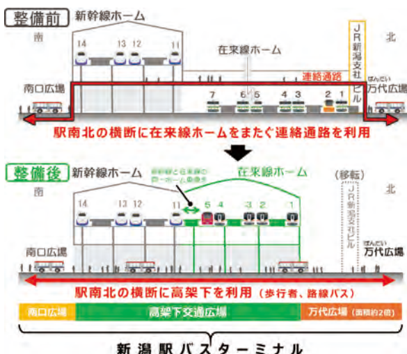
図－1 新潟駅における在来線高架化断面図
