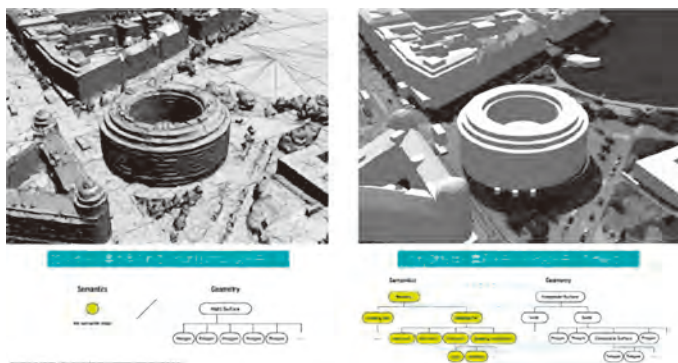
図ー1 ジオメトリモデル(左)とセマンティックモデル(右)のイメージ
