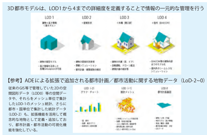
図ー2 LOD (Level of Detail) のイメージ
